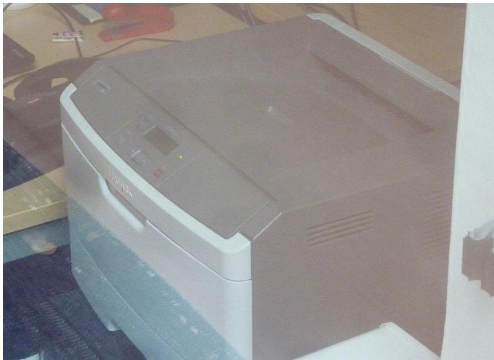
Jeder dieser Drucker hat laut Datenblatt eine Standby-Leistung von etwa 11 Watt. Nur bei diesen Druckern beträgt das österreichweite Einsparpotential etwa 100.000 kWh.
